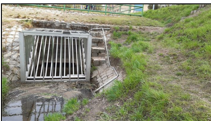
Abb. 1. Digitaler Wasserstandsmesspegel (hier 2 Drucksonden) BÜW003 im HRB Kaitzbach 1 Hugo-Bürkner-Park, 15.04.2020
